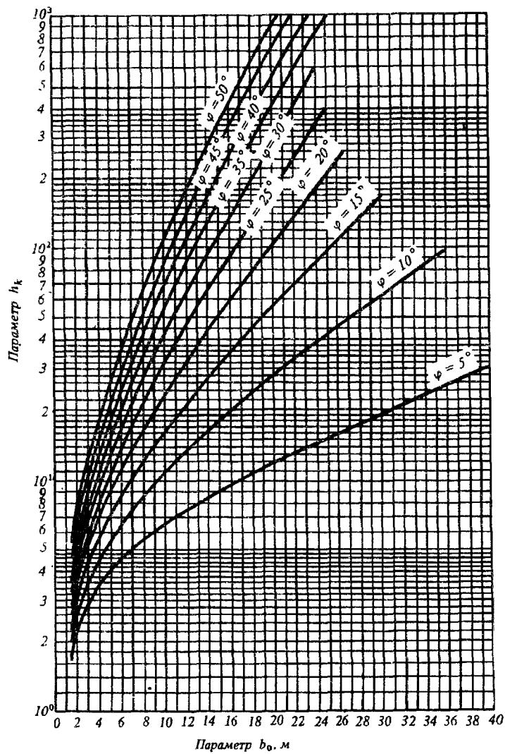
Черт. 6. Графики для определения параметра  $b_0$
