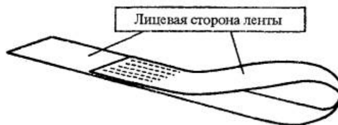
Рис. 5. Плоская петля стропа
