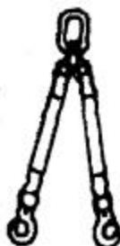
Рис. 5. Двухветвевое строповочное устройство
