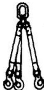
Рис. 6. Трехветвевое строповочное устройство
