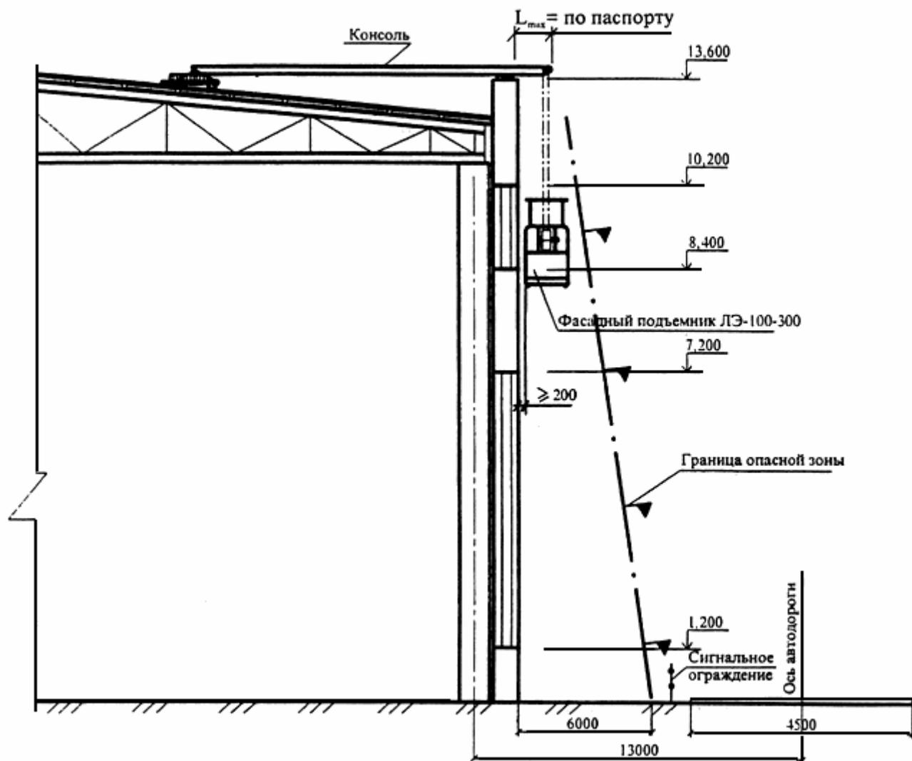
**Рисунок 38 - Схема привязки фасадного подъемника для устройства остекления**
