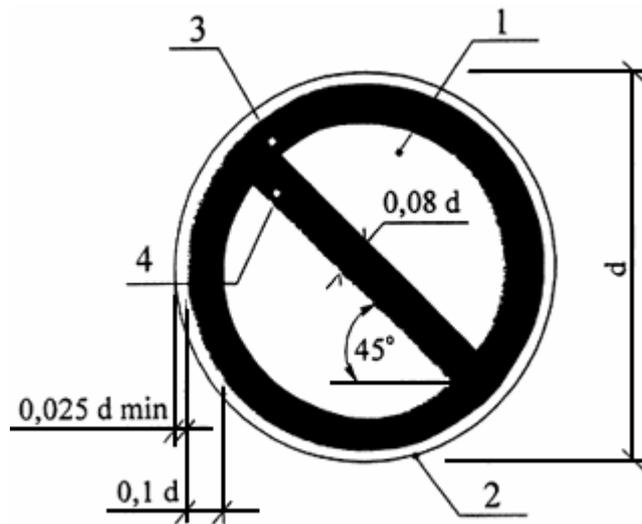
$d$  - диаметр круга; 1 - основная поверхность; 2 - кант; 3 - кайма; 4 - поперечная полоса
