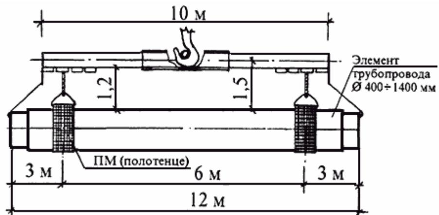
Траверса для разгрузки труб Ø 400 ÷ 1400 мм  $Q = 18$  тс,  $P = 1530$  кг
