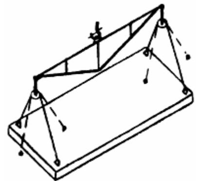
Траверса грузоподъемностью 20 тонн
