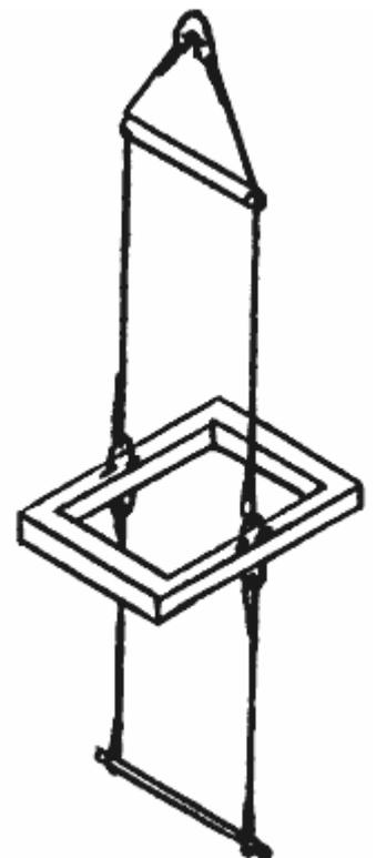
Траверса для подъема железобетонных фахверковых колонн
