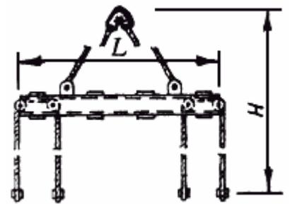
Траверса для подъема и монтажа крупнопанельных перегородок
