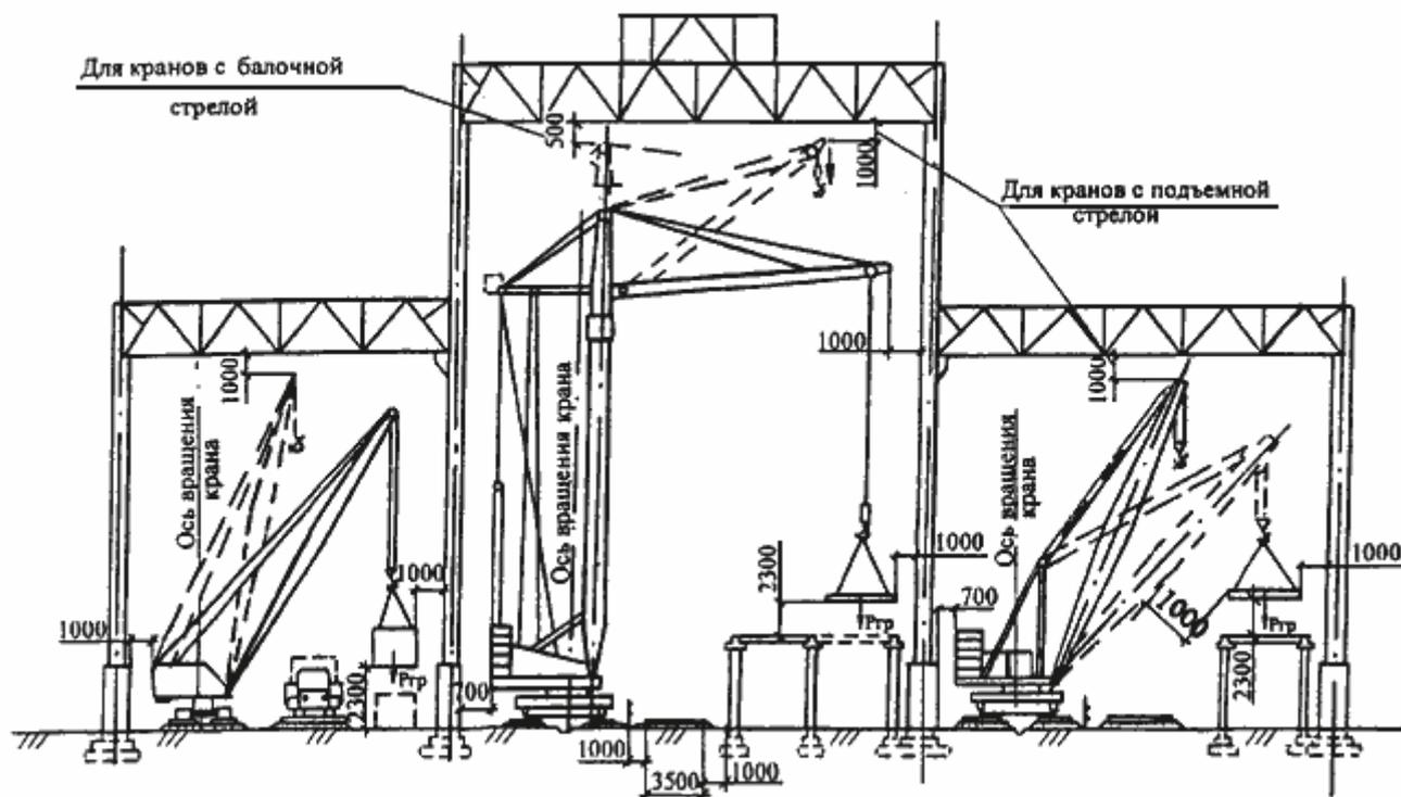
Рисунок 11 - Привязка крана внутри строящегося или реконструируемого здания
