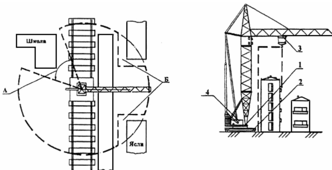
А - ограничение поворота стрелы; Б - ограничение вылета грузовой тележки.
