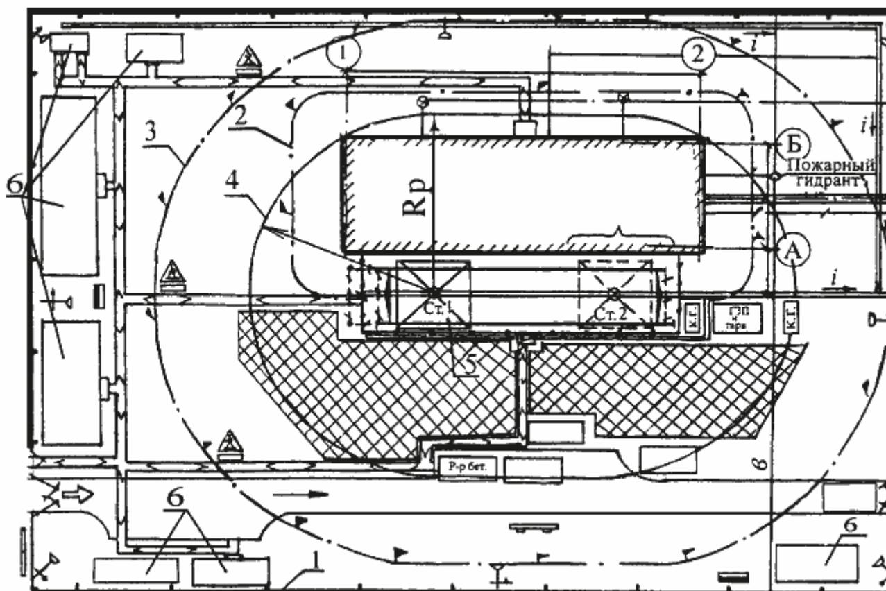
1 - ограждение строительной площадки; 2 - граница опасной зоны вблизи строящегося здания; 3 - граница зоны, опасной для нахождения людей во время перемещения, установки и закрепления элементов и конструкций\*; 4 - граница зоны обслуживания краном; 5 - башенный кран; 6 - санитарно-бытовые помещения.
