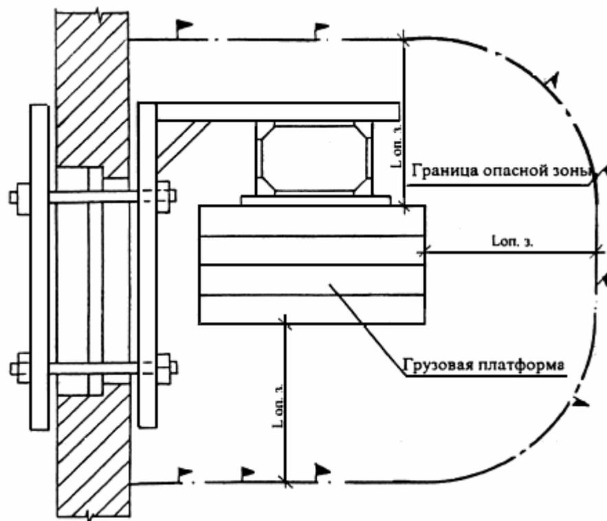
**Рисунок 16 - Опасная зона при работе грузового строительного подъемника**
