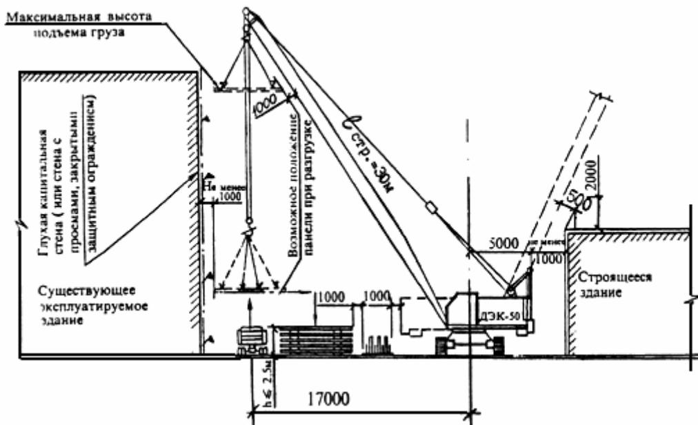
Примечание - У глухой капитальной стены или стены с проемами, закрытыми защитным ограждением, груз может перемещаться на расстоянии не менее 1 м, если максимальная высота подъема груза меньше высоты здания и в опасной зоне от перемещения груза краном отсутствуют входы в существующее здание.
