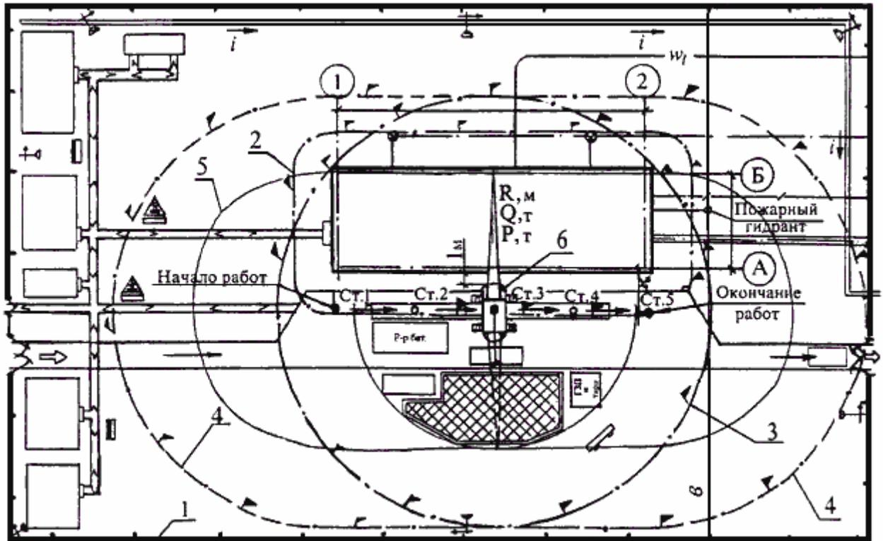
1 - ограждение строительной площадки; 2 - граница опасной зоны вблизи строящегося здания; 3 - граница зоны, опасной для нахождения людей во время перемещения, установки и закрепления элементов и конструкций на одной стоянке\*; 4 - то же, с учетом всех стоянок; 5 - граница зоны обслуживания краном; 6 - стреловой кран.
