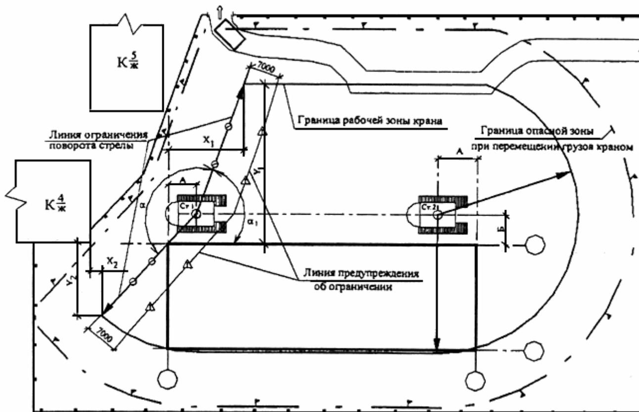
Лучи угла ограничения поворота стрелы крана должны быть привязаны при помощи координат
