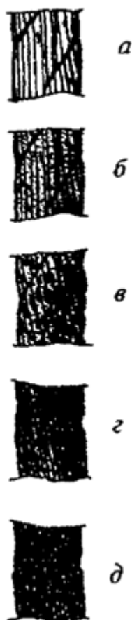
Рисунок 6. Поверхностная коррозия проволок каната крестовой свивки: а - начальное окисление поверхности; б - общее окисление поверхности; в - заметное окисление; г - сильное окисление; д - интенсивная коррозия
